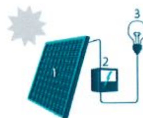
1. Zonnepaneel | 2. Omvormer 3. Elektrische toestellen
